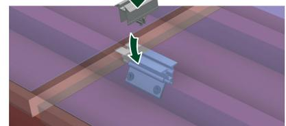
4. Zwischen den Modulen Mittelklemmen verwenden und diese ebenfalls mit einem Anzugsmoment von 6 Nm fixieren. Die Modulreihe (horizontale Modulausrichtung) mit einer Endklemme abschließen.
